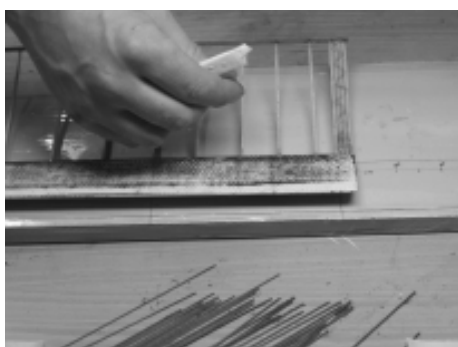
Dags för vår glasyrstrut! Spruta på 24h epoxy på alla limytor
